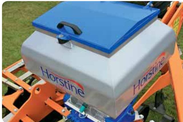
Рис. 20. Дозатор-аплікатор для внесення гранульованих пестицидів, обладнаний на саджалку
