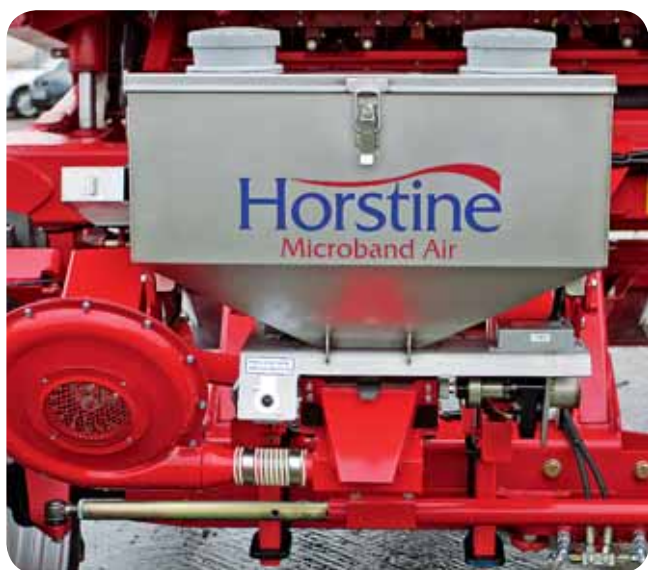
Рис. 19. Дозатор-аплікатор для внесення гранульованих пестицидів у ґрунт
